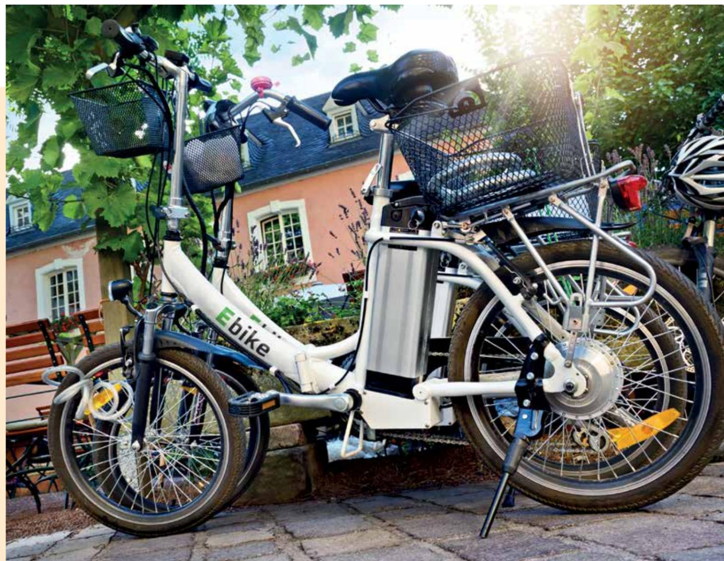
Unabhängig von der Klasse der Elektrofahrräder sind diese durch die zusätzlichen Komponenten 8 bis 10 kg schwerer als ihre Pendanten ohne Hilfsmotor. Zusammen mit der höheren Geschwindigkeit, die in der Regel gefahren wird, stellt dies besondere Anforderungen an Bremsen, Rahmen und Räder. Diese sollten entsprechend der höheren Belastung ausgelegt und auch getestet sein. Bei den Bremsen werden Typen mit hydraulischer Unterstützung und Verschleißanzeige empfohlen.
