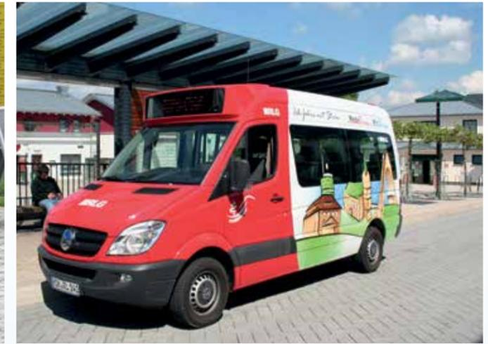
Bemerkenswert ist, dass der Elektrokleinbus aufgrund des höheren Wirkungsgrades des Elektromotors im Vergleich zu seinem mit Diesel bei der RLG betriebenen „Zwillingsfahrzeug“ rund viermal energieeffizienter unterwegs ist.
