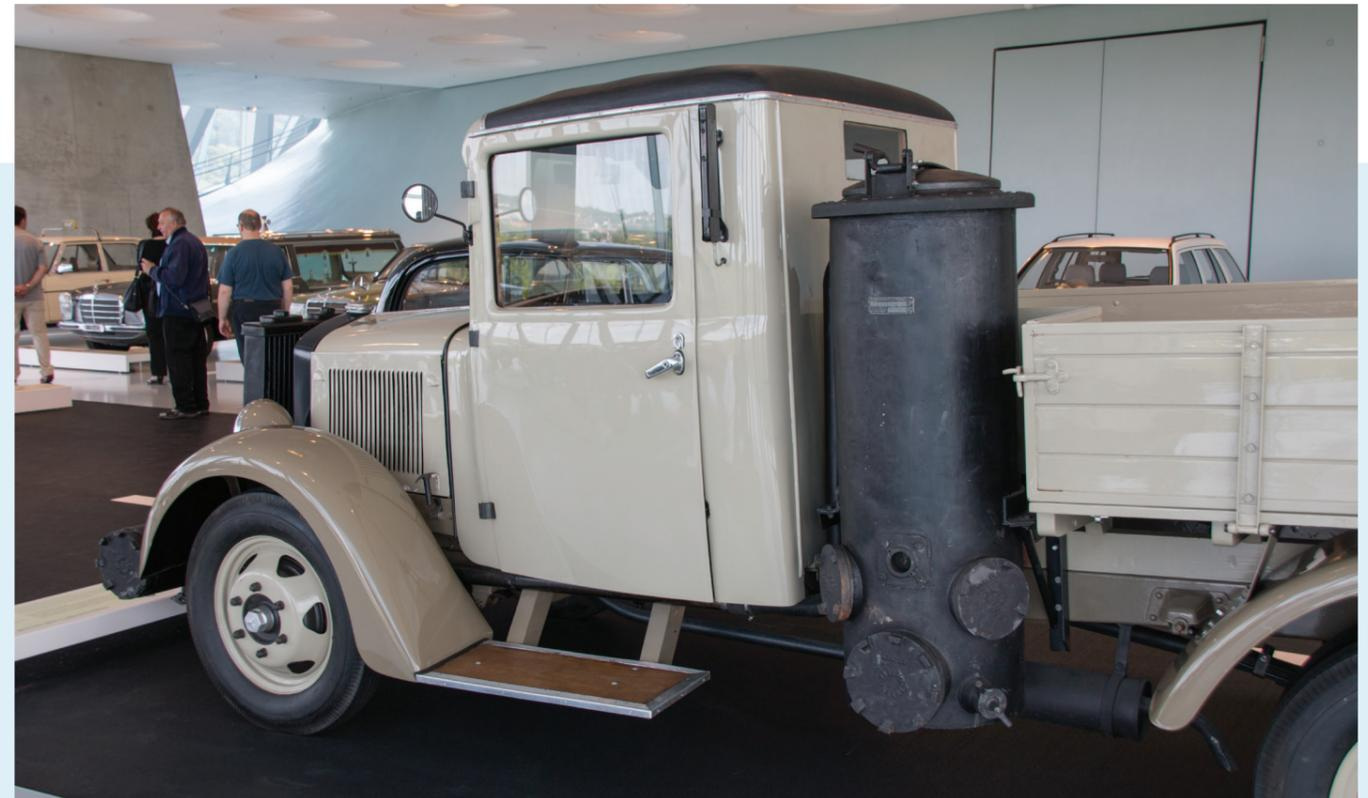
Bei einem Holzgasauto wurde Holz bei geringer Sauerstoffzufuhr verkohlt. Die entstehenden Gase wurden zu einem Filter geleitet und anschließend dem Motor zugeführt. Je nach Holzart wurden zwischen 30 und 45 PS erreicht.
