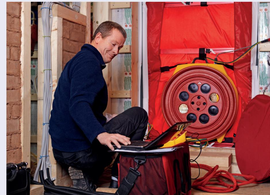
schon mit der Hand erfühlen. Um kleinere Leckagen zu orten, benötigt man allerdings weitere Hilfsmittel wie künstlichen Rauch oder eine Nebelmaschine. Auch Luftgeschwindigkeitsmesser und Infrarotkameras werden zur genaueren Diagnose eingesetzt. Danach sind gezielte Nachbesserungen der Undichtigkeiten möglich.
