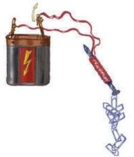
Wenn nur eine Büroklammer am Magneten hängt, kann es sein, dass sie nach dem Abschalten nicht herunterfällt. Der Strom hat den Nagel zu einem schwachen Dauermagneten gemacht, er ist aber lange nicht so stark wie vorher. Du kannst versuchen, mehrere Büroklammern anzuhängen, dann siehst du es!
